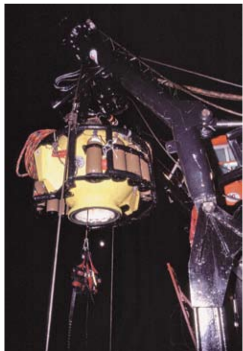
Recupero notturno della campana con i due OTS all'interno dopo 10 ore di lavoro a 100 metri di fondo.
