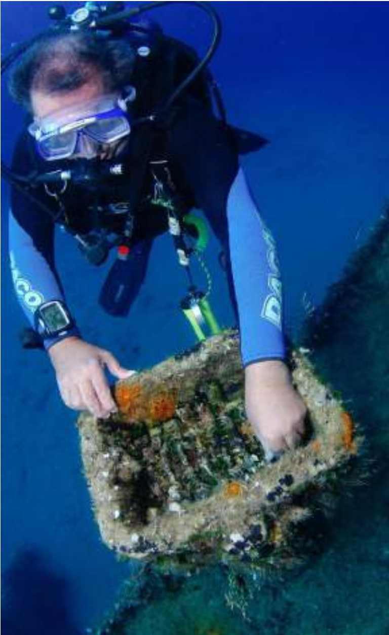
Foto 051: una torretta di manovra elettromeccanica con delle molle ancora elastiche. Si trova sul ponte sopra il quadro comandi interno della nave.
